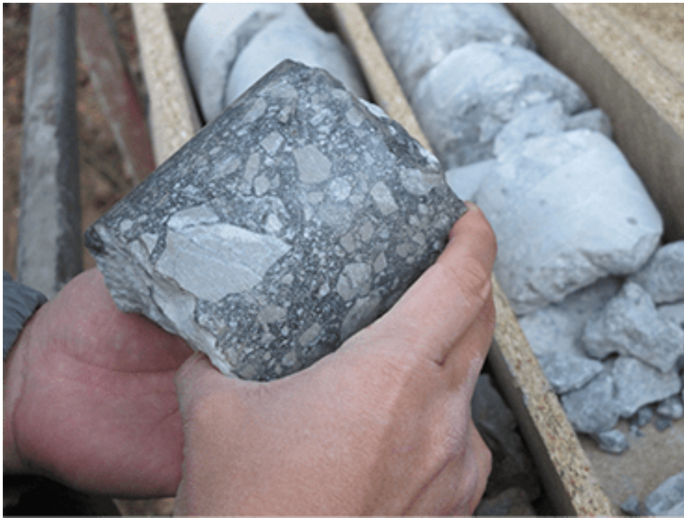
La carotte extraite contient un échantillon de la brèche de faille © V. Bertrand, Eost/Résif
